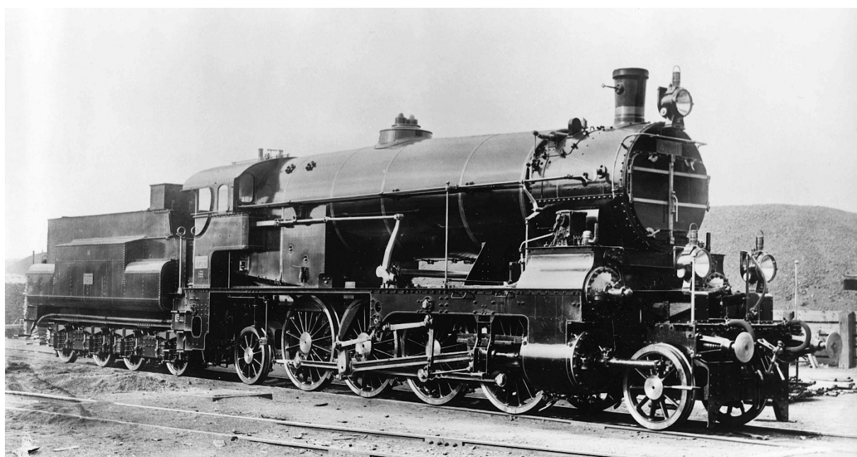
Prototypový stroj 470.01 z roku 1914 na továrním snímku. Mohutné šoupátkové komory ukrývají pístová šoupátka se čtyřmi kotouči, která rozváděla páru pro vnitřní vysokotlaké i vnější nízkotlaké válce, čímž se výrazně zjednodušil rozvodový mechanismus mezi rámem.
