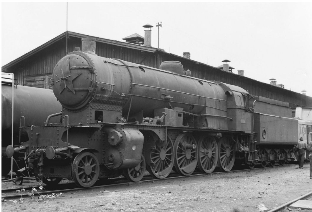
Bývalá 455.004 jako vytápěcí kotel K75 ve stanici Bratislava-Nivy, 1968.
